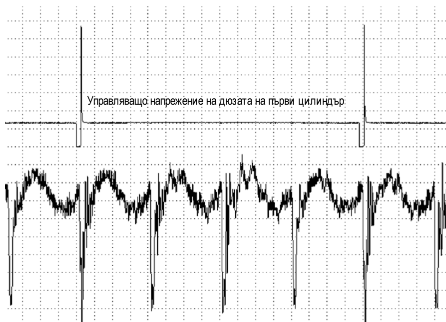
Осцилограма на сигнала от мембраната на регулатора на налягането на горивото при Opel. Дюзите са замърсени.
